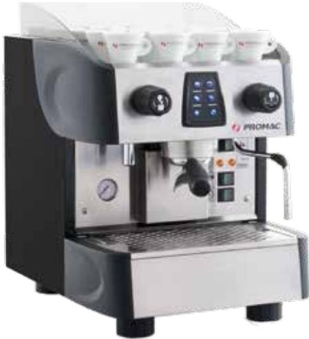
Gehäuse aus Edelstahl, Verkleidung grau, elektronische Kaffeedosierung (Selbstspeicherung), automatischer Wasserniveauregler, eingebaute volumetrische Elektropumpe, manuelle Kaffeedosierungstaste, Druckmesser mit Doppelanzeige, Inox-Dampfhahn, 1 Heißwasserhahn, Boiler 4 Liter
