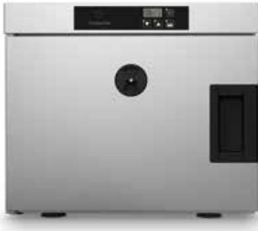
statisches Ring-Heizsystem mit Thermokabel, optimales Heißhalten durch exakte und kompakte „stille Wärme“, 2 einstellbare Entlüftungen, dichter Garraum mit Wärmeisolierung 35 mm und abgerundeten Ecken für perfekte Hygiene, niedriger Energieverbrauch, Bedienfeld mit elektronischer Einstellung für die Temperaturen, Kapazität für 3 Einschübe GN 1/1 (530x325 mm), Einschubabstand 70 mm, Temperaturbereich 30°-120°C
